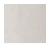
Sichtbeton (Schalungsglatte Beton, Rücken geglättet)
