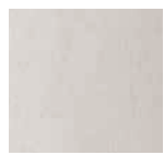
Sichtbeton (Schalungsglatte Beton, Rücken geglättet)
